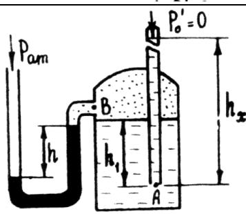
**Задача 5.** Определить при атмосферном давлении  $p_{at}$  высоту  $h_x$  поднятия ртути в дифференциальном манометре, подсоединенном к закрытому резервуару в точке B, частично заполненному дистиллированной водой, если глубина погружения точки A от свободной поверхности резервуара  $h_1$ , приведенная пьезометрическая высота поднятия воды в закрытом пьезометре (соответствующая абсолютному гидростатическому давлению в точке A)  $h_2$ .
