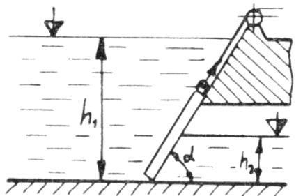
**Задача 8.** Для сброса излишков воды используется донный водовыпуск, прямоугольный затвор которого имеет размеры  $a$  и  $b$ , угол наклона  $\alpha$ . Глубина воды от ее свободной поверхности до нижней кромки затвора —  $h_1$ . Определить силу избыточного гидростатического давления жидкости на затвор водовыпуска.
