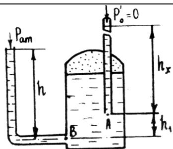
**Задача 3.** Определить абсолютное гидростатическое давление в точке A закрытого резервуара с дистиллированной водой, если при атмосферном давлении  $p_{at}$  высота столба ртути в трубке дифманометра  $h$ , а линия раздела между ртутью и водой расположена ниже точки B на величину  $h_1$ , точка B — выше точки A на величину  $h_2$ .
