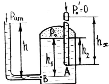
**Задача 2.** Закрытый резервуар с морской водой снабжен открытым и закрытым пьезометрами. Определить приведенную пьезометрическую высоту  $h_x$  поднятия воды в закрытом пьезометре (соответствующую абсолютному гидростатическому давлению в точке A), если показание открытого пьезометра  $h$  при атмосферном давлении  $p_{at}$ , а точка A расположена выше точки B на величину  $h_1$ .
