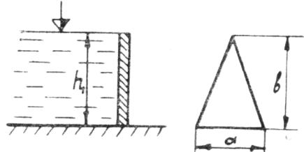
**Задача 7.** Плоский квадратный щит шириной  $b$  установлен с углом наклона  $\alpha$  к горизонту. Глубина воды перед щитом —  $h_1$  защиты —  $h_2$ . Определить силу абсолютного гидростатического давления и центр давления жидкости на щит.
