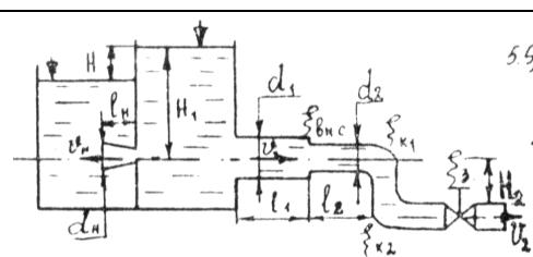
сопротивления задвижки  $\xi_3$ . Истечение из конически расходящегося насадка с диаметром выходного сечения  $d_h$  и длиной  $l_h = 5d_h$  происходит под уровень при постоянной разности уровней  $H$ . Коэффициент скорости и коэффициент расхода насадка равны  $\phi_h = \mu_{h*}$ .
