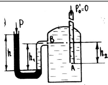
**Задача 4.** Закрытый резервуар снабжен дифманометром, установленным в точке B, и закрытым пьезометром. Определить приведенную пьезометрическую высоту  $h_x$  поднятия пресной воды в закрытом пьезометре (соответствующую абсолютному гидростатическому давлению в точке A), если при атмосферном давлении  $p_{at}$  высота столба ртути в трубке дифференциального манометра  $h$ , а точка A расположена на глубине  $h_1$  от свободной поверхности.
