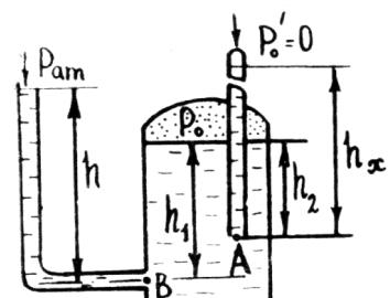
**Задача 2.** Закрытый резервуар с морской водой снабжен открытым и закрытым пьезометрами. Определить приведенную пьезометрическую высоту  $h_x$  поднятия воды в закрытом пьезометре (соответствующую абсолютному гидростатическому давлению в точке А), если показание открытого пьезометра  $h$  при атмосферном давлении  $p_{atm}$ , а точка А расположена выше точки В на величину  $h_1$ .
