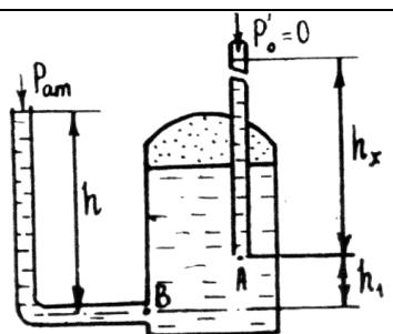
**Задача 3.** Определить абсолютное гидростатическое давление в точке А закрытого резервуара с дистиллированной водой, если при атмосферном давлении  $p_{at}$  высота столба ртути в трубке дифманометра  $h$ , а линия раздела между ртутью и водой расположена ниже точки В на величину  $h_1$ , точка В — выше точки А на величину  $h_2$ .
