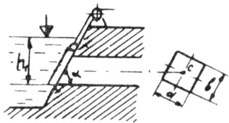
**Задача 9.** Затвор донного водовыпуска треугольной формы имеет ширину  $a$  и высоту  $b$ . Угол наклона затвора  $\alpha$ , нижняя кромка затвора находится в воде на глубине  $h_1$ . Определить силу абсолютного гидростатического давления жидкости и положение центра давления на затвор.
