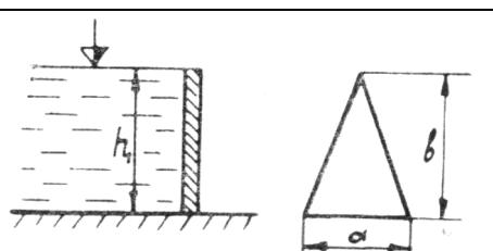
**Задача 7.** Плоский квадратный щит шириной  $b$  установлен с углом наклона к горизонту  $\alpha$ . Глубина воды перед щитом —  $h_1$  за щиты —  $h_2$ . Определить силу абсолютного гидростатического давления и центр давления жидкости на щите.
