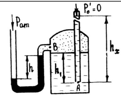
**Задача 5.** Определить при атмосферном давлении  $p_{at}$  высоту  $h_x$  поднятия ртути в дифференциальном манометре, подсоединенным к закрытому резервуару в точке В, частично заполненному дистиллированной водой, если глубина погружения точки А от свободной поверхности резервуара  $h_1$ , приведенная пьезометрическая высота поднятия воды в закрытом пьезометре (соответствующая абсолютному гидростатическому давлению в точке А)  $h_2$ .
