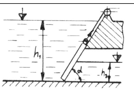
**Задача 8.** Для сброса излишков воды используется донный водовыпуск, прямоугольный затвор которого имеет размеры  $a$  и  $b$ , угол наклона  $\alpha$ . Глубина воды от ее свободной поверхности до нижней кромки затвора —  $h_1$ . Определить силу избыточного гидростатического давления жидкости на затвор водовыпуска.
