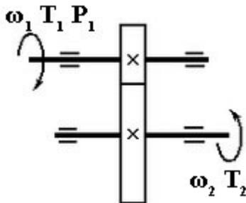
Для изображенной на схеме передачи определить вращающий момент  $T_2$  на ведомом валу.
