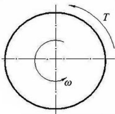
Какую мощность развивает вращающийся диск, если его угловая скорость  $\omega = 10\pi$  (рад/сек), а вращающий момент  $T$  равен 50 Нм?
