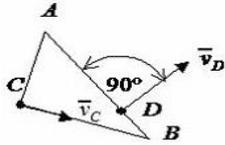
Если в положении, показанном на рисунке, скорость точки  $C$  равна  $6\text{ м/с}$ , то мгновенная угловая скорость треугольника  $\omega$  равна \_\_\_\_\_  $\text{с}^{-1}$ .
