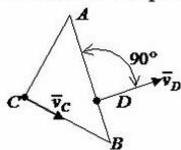
Если в положении, показанном на рисунке, скорость точки  $C$  равна  $36\text{ м/с}$ , то мгновенная угловая скорость треугольника  $\omega$  равна \_\_\_\_\_  $\text{с}^{-1}$ .
