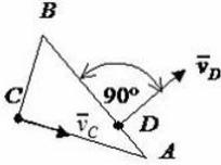
Если в положении, показанном на рисунке, скорость точки  $C$  равна 20 м/с, то мгновенная угловая скорость треугольника  $\omega$  равна \_\_\_\_\_ с<sup>-1</sup>.
