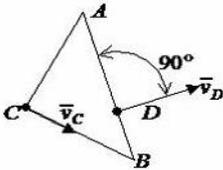
Если в положении, показанном на рисунке, скорость точки  $C$  равна 36 м/с, то мгновенная угловая скорость треугольника  $\omega$  равна \_\_\_\_\_ с<sup>-1</sup>.
