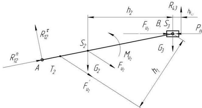
17. Определите модуль и направление главного вектора сил инерции шатуна, если известно, что  $a_C = 17,8 \text{ м/с}^2$ ;  $a_{S_2} = 17,4 \text{ м/с}^2$ ;  $a_{CB}^r = 15,3 \text{ м/с}^2$ ;  $\varepsilon_2 = 13,8 \text{ рад/с}^2$ ;  $m_1 = \quad \text{кг}$ ;  $m_2 = \quad \text{кг}$ ;  $m_3 = \quad \text{кг}$ .
