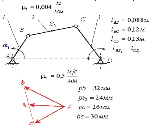
15. Определить величину уравновешивающей силы из рычага Жуковского, если известны силы  $G_2 = \dots \text{ Н}$ ,  $F_{и2} = \dots \text{ Н}$ ,  $F_{и3} = \dots \text{ Н}$ ,  $P_{пс} = \dots \text{ Н}$ .
