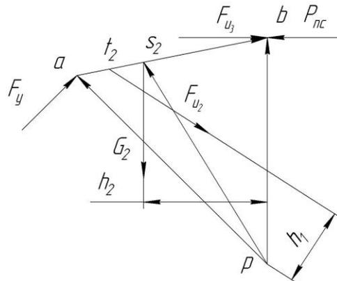
16. Определить величину реакции  $R_{12}^r$  для заданной на схеме структурной группы, если известны значения:  $G_2 = \quad \text{Н}$ ,  $F_{u2} = \quad \text{Н}$ ,  $F_{u3} = \quad \text{Н}$ ,  $P_{nc} = \dots\dots\dots \text{Н}$ .
