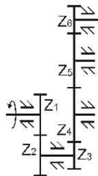
29. Если  $Z_1 = 20$ ,  $Z_2 = 10$ ,  $Z_3 = 40$ , то передаточное отношение редуктора равно ...
