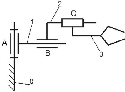
8. Определить класс механизма, приведенного на кинематической схеме
