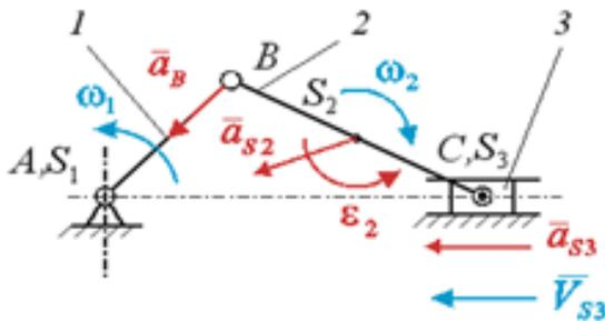
18. Вычислить кинетическую энергию звена 2 механизма кинематическая схема и план скоростей которого приведены на рисунке, если масса звена 2  $m_2 = 5 \text{ кг}$ , а момент инерции  $J_{S_2} = 0,006 \text{ кг}\cdot\text{м}^2$
