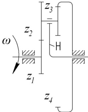
5. Проверить выполнение условия соосности планетарного механизма, для которого  $m_{12} = 4 \text{ мм}$ ;  $m_{34} = 5 \text{ мм}$ ;  $z_1 = 20$ ;  $z_2 = 40$ ;  $z_3 = 22$ ;  $z_4 = 70$ .
