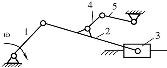
9. Определить класс механизма, приведенного на кинематической схеме
