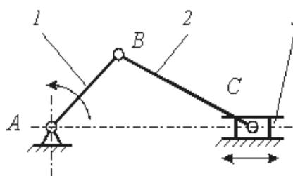
45. На рисунке приведена кинематическая схема кривошипно-ползунного механизма компрессора. Ускорение выходного звена – ползуна 3 определяется зависимостью
