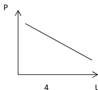
7. Типовая статическая характеристика реактивной нагрузки по напряжению имеет вид
