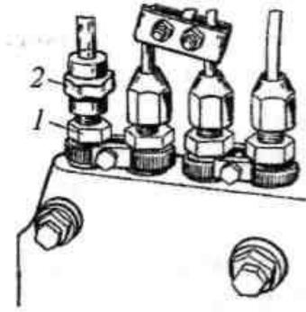
1 - штуцер топливного насоса;
