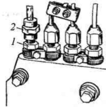
1 - штуцер топливного насоса;
