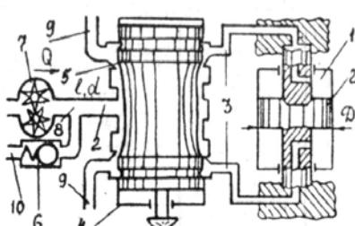
**Задача 19.** Экскаватор гидравлический Э-153 имеет гидросистему, содержащую основные элементы: силовой цилиндр 1 (рабочее усилие которого  $N$ ) с поршнем 2 диаметром  $D$ , соединенными трубопроводами 3 с распределителем 4, имеющим золотник 5, нагнетательный трубопровод 6, насос 7 с подачей  $Q$ , предохранительный клапан 8 и сливные трубопроводы 9 и 10. Длина нагнетательного трубопровода  $l$  и диаметр  $d$ .
