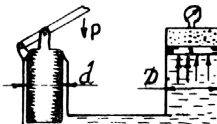
**Задача 10.** Два сообщающихся цилиндра наполнены водой. В левый цилиндр заключен поршень диаметром  $d$ , который уравновешивается столбом жидкости  $H = 0,35$  м в правом цилиндре. Определить вес поршня  $G$ . Трением пренебречь.
