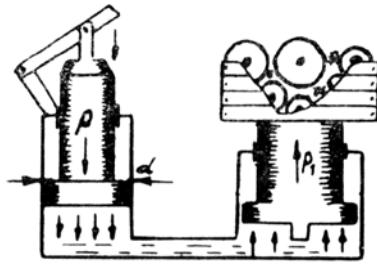
**Задача 8.** Два вертикальных цилиндра наполнены жидкостью и сообщаются между собой. В цилиндры заключены поршни (левый — диаметром  $d$ , правый — диаметром  $D$ ), которые находятся в равновесии, причем, над правым: поршнем находится воздух при атмосферном давлении  $p = 98,1$  кПа. Определить, какую надо приложить силу  $P$  к левому поршню (направленную вертикально вверх), чтобы давление воздуха над правым поршнем уменьшилось на 15%. Трением и массой поршня пренебречь.
