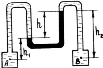
**Задача 3.** Резервуары А и В частично заполнены водой разной плотности (соответственно  $\rho_A = 998 \text{ кг}/\text{м}^3$ ,  $\rho_B = 1029 \text{ кг}/\text{м}^3$ ) и газом, причем, к резервуару А подключен баллон с газом. Высота столба ртути в трубке дифманометра  $h$ , а расстояния от оси резервуаров до мениска ртути равны  $h_1$  и  $h_2$ . Какое необходимо создать давление  $p_0$  в баллоне, чтобы получить давление  $p_B$  на свободной поверхности в резервуаре В?
