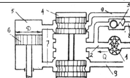
**Задача 14.** Свеклоуборочный комбайн КСТ-2 снабжен устройством для копирования контура междуурядий грядки, которое механически связано с гидросистемой комбайна. Эта система имеет силовой цилиндр 1 (рабочее усилие которого  $N$ ) с поршнем 2 диаметром  $D$ , соединенный через трубопроводы 3 с распределителем 4 с размещенным в нем золотником 5; нагнетательный трубопровод 6 длиной  $l$  и диаметром  $d$ , предохранительный клапан 7, гидронасос 8 с подачей  $Q$ , сливные трубопроводы 9 и 10.
