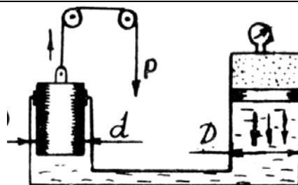
**Задача 9.** Система, состоящая из двух вертикальных цилиндров, соединенных между собой, заполнена жидкостью. В цилиндры заключены поршни диаметрами  $d$  и  $D$ . В пространстве над правым поршнем — воздух при атмосферном давлении  $p = 98,1$  кПа. Как изменится давление воздуха над правым поршнем, если к левому поршню приложить вертикально вниз силу  $P$ ? Трением пренебречь.
