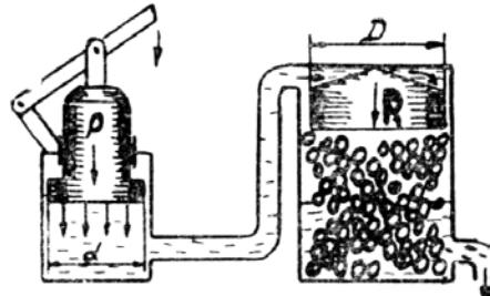
**Задача 7.** При ремонте с.-х. машин и оборудования широко используется гидравлический домкрат с диаметрами поршней  $D$  и  $d$ . Определить усилие  $P$ , которое необходимо приложить к малому поршню, чтобы поднять груз весом  $G$ .
