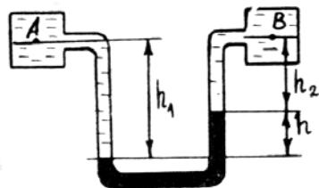
**Задача 2.** Дифференциальный ртутный манометр подключен к двум закрытым резервуарам с пресной водой, давление в резервуаре А равно  $p_A$ . Определить давление в резервуаре В —  $p_B$ , составив уравнение равновесия относительно плоскости равного давления, определить разность показания ртутного дифманометра  $h$ .
