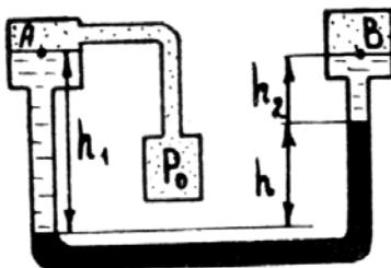
**Задача 4.** К двум резервуарам А и В, заполненным нефтью, присоединен дифференциальный ртутный манометр. Определить разность давлений в точках А и В, составив уравнение равновесия относительно плоскости равного давления. Разность показаний манометра  $h$ .
