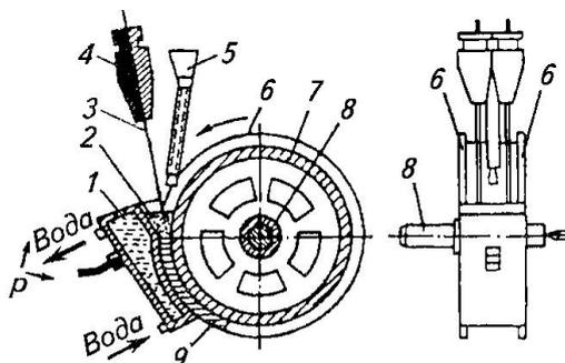
1 — кристаллизатор; 2 — шлаковая ванна; 3 — электрод; 4 — муфштук; 5 — дозатор легирующих добавок; 6 — крупногабаритные диски; 7 — восстанавливаемая деталь; 8 — оправка; 9 — покрытие
