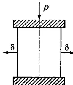
71. По схеме определите способ восстановления детали пластическим деформированием:
