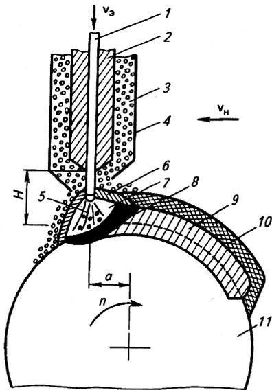
1 – электрод; 2 – мундштук; 3 – флюс; 4 – флюсопровод; 5 – электрическая дуга; 6 – расплавленный флюс; 7 – газовая (газошлаковая) оболочка; 8 и 9 – расплавленный и наплавленный металл; 10 – шлаковая корка; 11 – деталь;  $H$  – вылет электрода;  $a$  – смещение электрода с зенита;  $v_s$  – скорость подачи электродной проволоки;  $v_n$  – скорость наплавки;  $n$  – частота вращения детали
