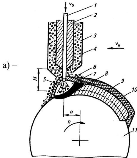
1 – электрод; 2 – мундштук; 3 – флюс; 4 – флюсопровод; 5 – электрическая дуга; 6 – расплавленный флюс; 7 – газовая (газошлаковая) оболочка; 8 и 9 – расплавленный и наплавленный металл; 10 – шлаковая корка; 11 – деталь; H – вылет электрода; a – смещение электрода с зенита;  $v_3$  – скорость подачи электродной проволоки;  $v_H$  – скорость наплавки; n – частота вращения детали
