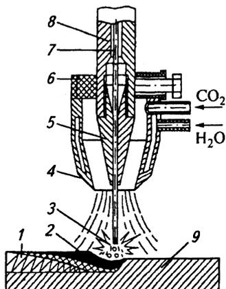
1 – наплавленный металл; 2 – сварочная ванна; 3 – электрическая дуга; 4 – сопло горелки; 5 – наконечник; 6 – горелка; 7 – электродная проволока; 8 – мундштук; 9 – наплавливаемая деталь
