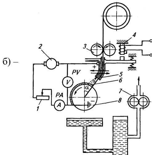
1 – реостат; 2 – сварочный преобразователь; 3 – механизм подачи электродной проволоки; 4 – вибратор; 5 – мундштук; 6 – электродная проволока; 7 – насос для подачи охлаждающей жидкости; 8 – наплавляемая деталь
