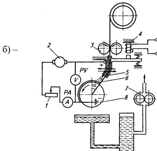
1 – реостат; 2 – сварочный преобразователь;
