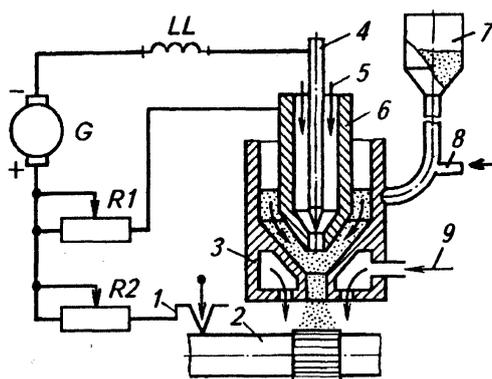
1 — привод; 2 — деталь; 3 — наружное сопло; 4 — вольфрамовый катод; 5 — плазмообразующий газ; 6 — внутреннее сопло — анод; 7 — питатель; 8 — транспортирующий газ; 9 — защитный газ; G — сварочный преобразователь; R1 и R2 — реостаты; LL — дроссель
