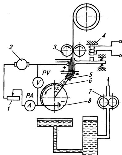
1 — реостат; 2 — сварочный преобразователь; 3 — механизм подачи электродной проволоки; 4 — вибратор; 5 — мундштук; 6 — электродная проволока; 7 — насос для подачи охлаждающей жидкости; 8 — наплавляемая деталь
