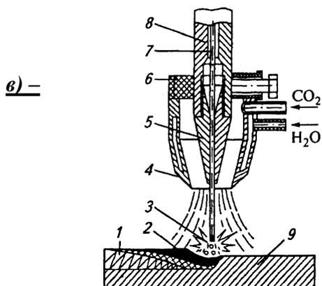
1 – наплавленный металл; 2 – сварочная ванна; 3 – электрическая дуга;
