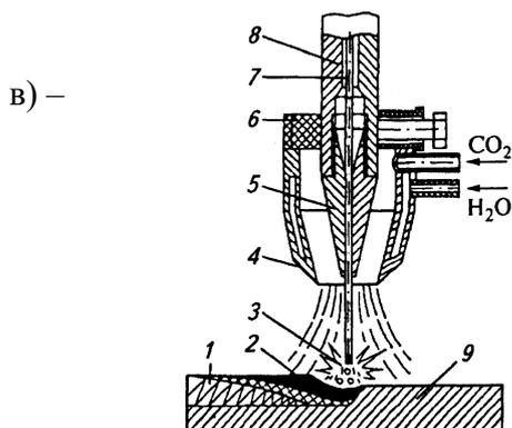
1 – наплавленный металл; 2 – сварочная ванна;
