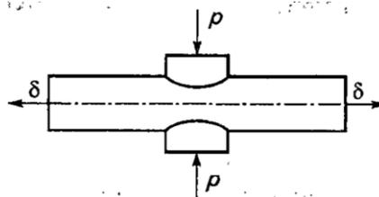
74. По схеме определите способ восстановления детали пластическим деформированием:
