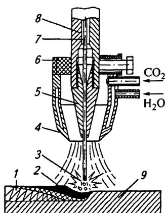
1 — наплавленный металл; 2 — сварочная ванна; 3 — электрическая дуга; 4 — сопло горелки; 5 — наконечник; 6 — горелка; 7 — электродная проволока; 8 — мундштук; 9 — наплавляемая деталь
