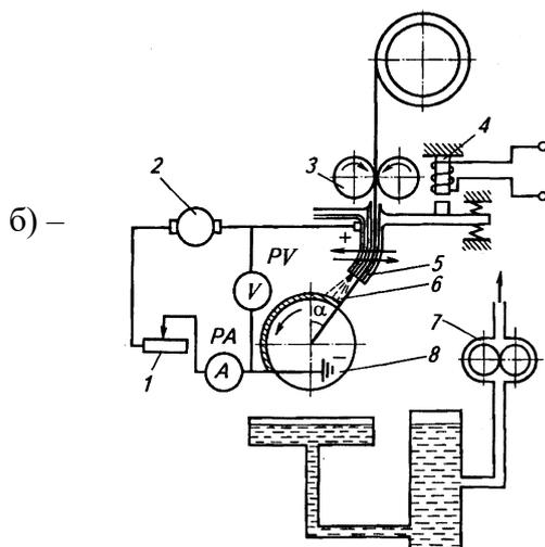
1 – реостат; 2 – сварочный преобразователь; 3 – механизм подачи электродной проволоки; 4 – вибратор; 5 – мундштук;
