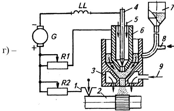
1 – привод; 2 – деталь; 3 – наружное сопло; 4 – вольфрамовый катод; 5 – плазмообразующий газ; 6 – внутреннее сопло – анод; 7 – питатель; 8 – транспортирующий газ; 9 – защитный газ; G – сварочный преобразователь; R1 и R2 – реостаты; LL – дроссель
