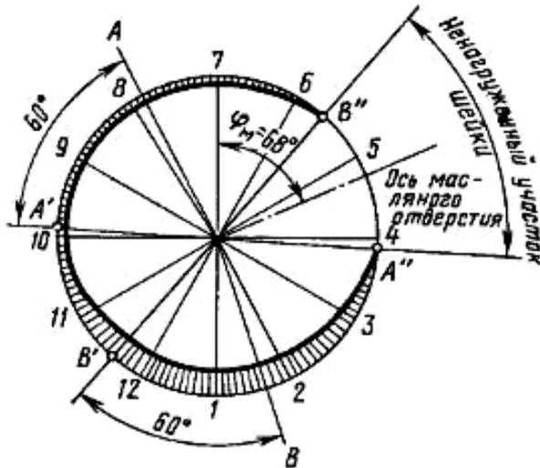
+диаграмму износа шатунной шейки карбюраторного двигателя
