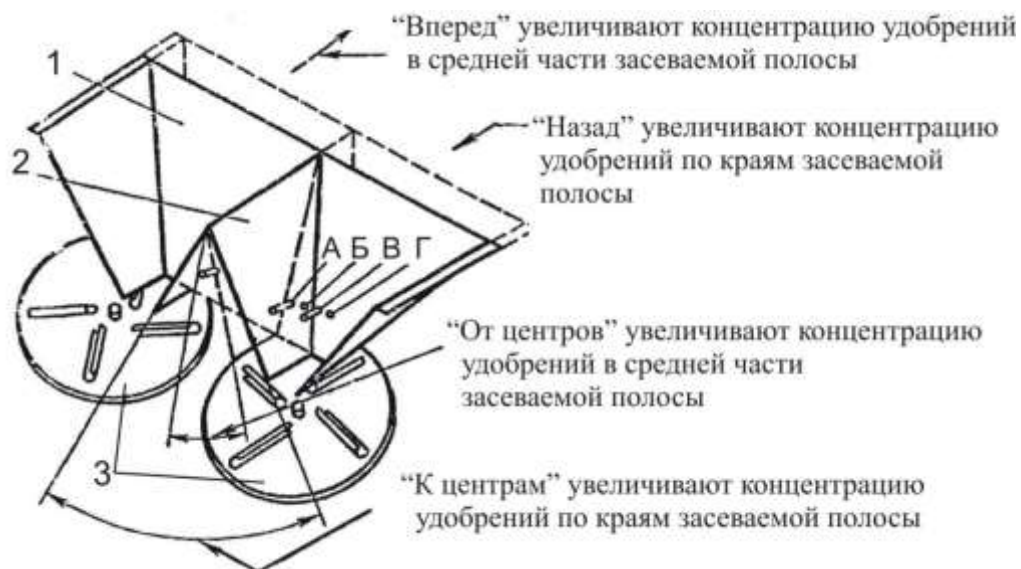
Рис. 5. Туконравитель и разбрасывающие диски:
