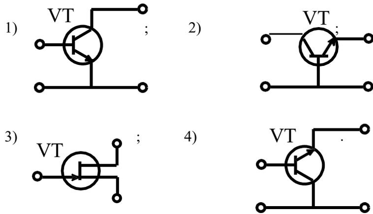
79. Схеме включения транзистора с общим эмиттером соответствует рисунок:
