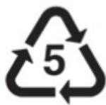
5. **PP** Определите материал, из которого изготовлено изделие, имеющее данную маркировку.
